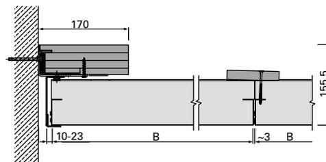
B-B | Anschluss an Beton-/Massivwand | flurstirnseitig | u146990
