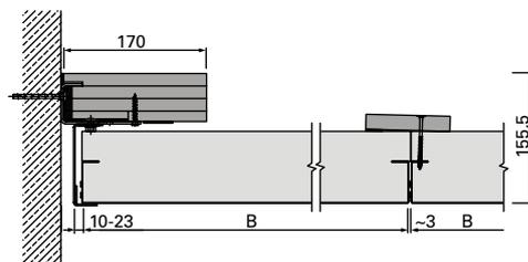
B-B | Anschluss an Beton-/Massivwand | flurstirnseitig | u144377
