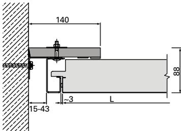
A-A | Anschluss an Beton-/Massivwand | mit geringer Aufbauhöhe | flurlängsseitig | u43062
