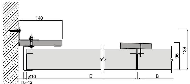
B-B | Anschluss an Beton-/Massivwand | flurstirnseitig | u137011
