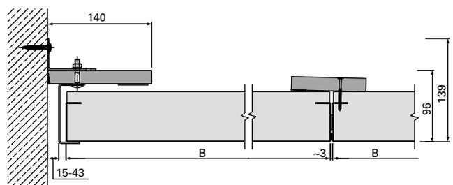
B-B | Anschluss an Beton-/Massivwand | flurstirnseitig | u138545
