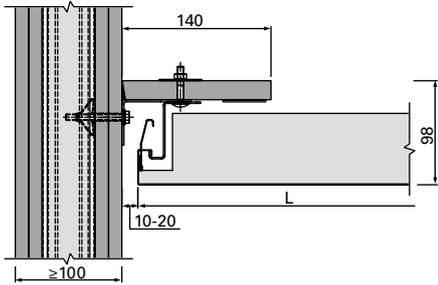
A-A | Anschluss an GK-Wand | mit geringer Aufbauhöhe | flurlängsseitig | u138548
