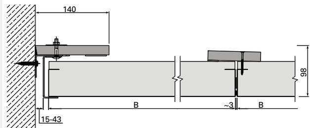
B-B | Anschluss an Beton-/Massivwand | mit geringer Aufbauhöhe | flurstirnseitig | u138549
