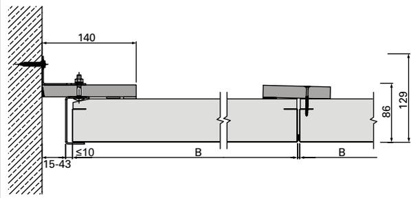
B-B | Anschluss an Beton-/Massivwand | flurstirnseitig | u43059
