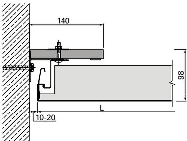
A-A | Anschluss an Beton-/Massivwand | mit geringer Aufbauhöhe | flurlängsseitig | u137026
