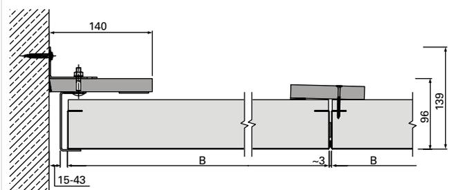
B-B | Anschluss an Beton-/Massivwand | flurstirnseitig | u138545
