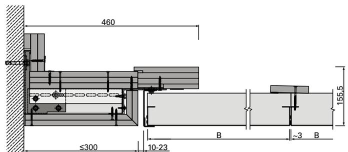
D-D | Anschluss an Beton-/Massivwand | mit Frieskonsole Lindner - Flex | flurstirnseitig | u145055
